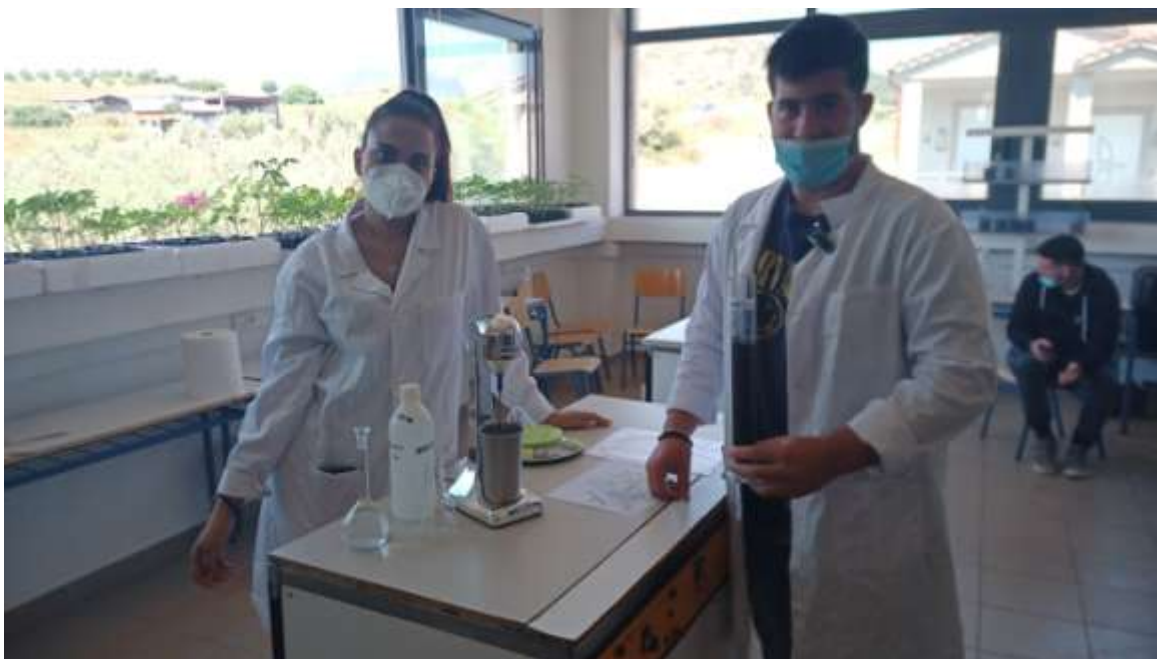
Εικόνα 2 : Διαδικασία μηχανικής ανάλυσης εδάφους
